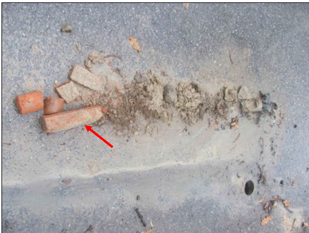
Foto 2: Pohled na výnos z jádrového vrtu pro určení tl. pásu klenby. Šipkou označena část cihelné klenby.
